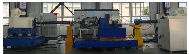
图14 混合动力综合性能试验台架
